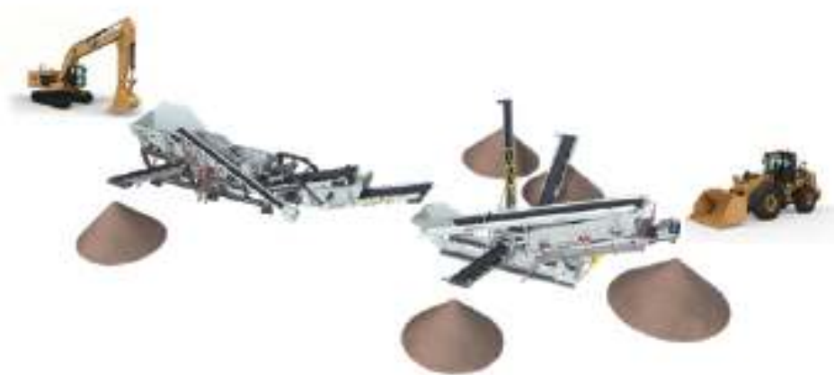
NF11313RSD+NFS350D 框架式软岩破碎筛分生产线
